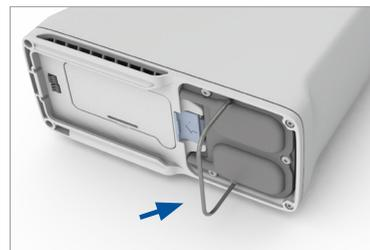
7. Retirez complètement les colonnes de l'Inogen One® G4. Les deux colonnes sont extraites en même temps.
