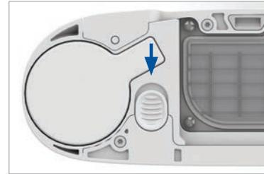
7. Tout en maintenant le bouton en position ouverte, faites glisser la colonne (tube métallique) hors de l'appareil en saisissant la surface en aluminium exposée avec votre autre main.
